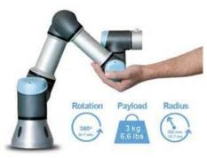
Les cobots UR existent en plusieurs versions, pour des charges utiles de 3, 5, 10 et 16 kg.
