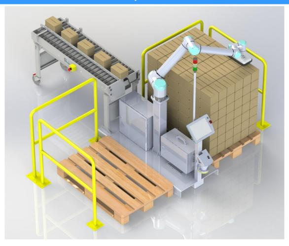
Cet équipement est un robot palettiseur dont l'élément central - un robot collaboratif performant et économique - évolue dans une application de conditionnement de produits manufacturés sur une palette.
